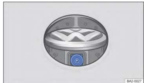
تصویر ۲۰۴ درب پشت: دوربین دنده عقب روی لوگوی فولکس واگن (تصویر)
