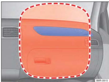
تصویر ۴۰ محل نصب و محدوده عملکرد کیسه هوای سرنشین جلو
