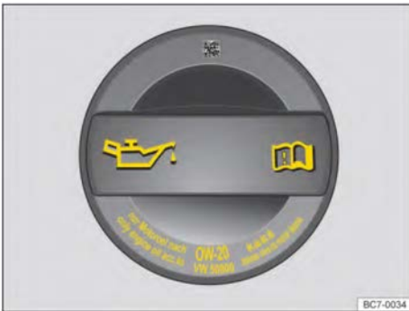
تصویر ۱۸۴ زیر درب موتور: درب مخزن روغن موتور (تصویر)
