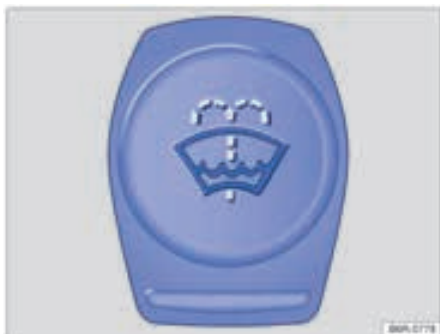
شکل ۱۳۸ : محفظه موتور: درپوش مخزن مایع شیشه شوی
