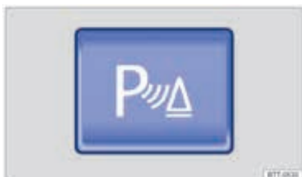
شکل ۱۵ : بخش بالایی کنسول مرکزی: دکمه برای روشن یا خاموش کردن سیستم هشدار فاصله پارک (نمای شماتیک)
