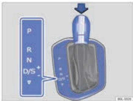
شکل ۸۸ : اهرم دنده اتوماتیک مجهز به دکمه قفل (فلش)
