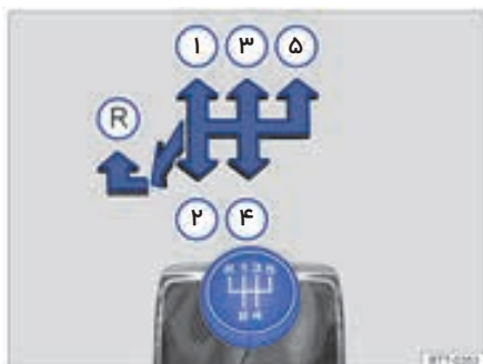
شکل ۸۷: دیاگرام شماتیک یک سیستم دنده دستی ۵ سرعت
