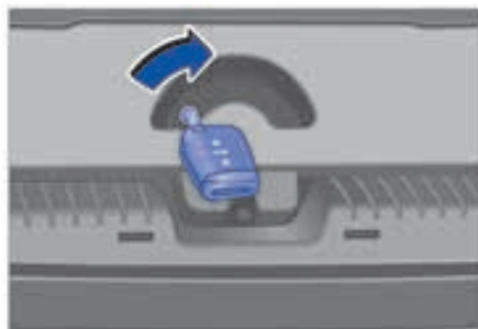
شکل ۵۱: در صندوق عقب: از قفل خارج کردن قفل درب صندوق عقب
