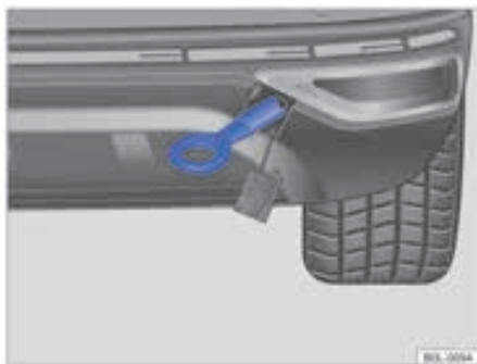
شکل ۱۳۲: قسمت بالایی سمت راست سپر عقب: حلقه بکسل که به داخل پیچانده شده است
