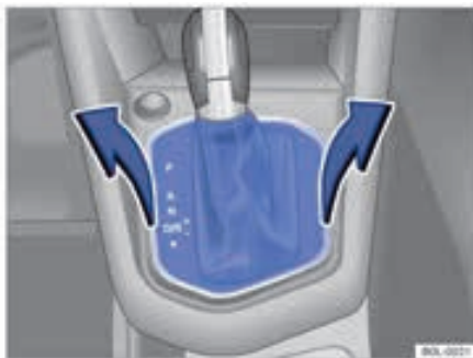
شکل ۹۰ : برداشتن کاور دنده
