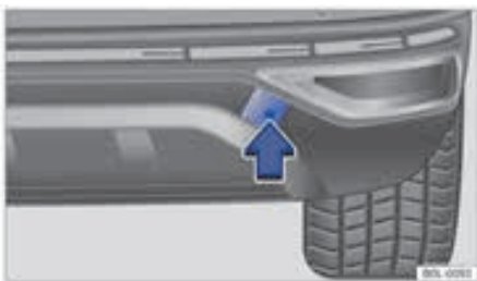
شکل ۱۳۱: قسمت بالایی سمت راست سپر عقب: برداشتن صفحه کاور
