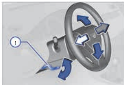
شکل ۵۳: بر روی پانل تریم ستون فرمان زیر فرمان: اهرم برای تنظیم مکانیکی موقعیت فرمان
