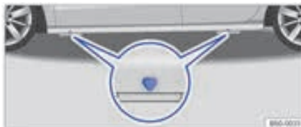
شکل ۱۵۶ : نقطه تکیه گاه جک
