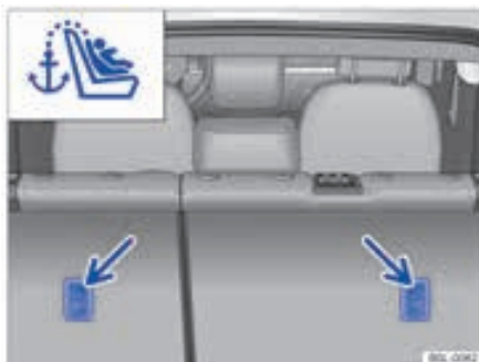
شکل ۳۸ : زیانه‌های نگهدارنده برای متصل کردن تسمه تاپ تتر بر روی پشתי صندلی ردیف عقب
