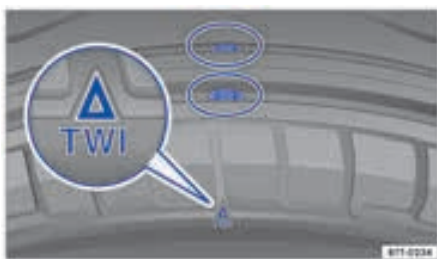
شکل ۱۵۰ : الگوی لاستیک: علامت های فرسودگی (نمودار شماتیک)
