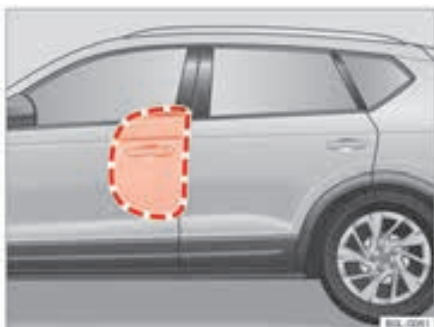
شکل ۳۱: سمت چپ خودرو: محدوده انبساط کیسه هوای جانبی
