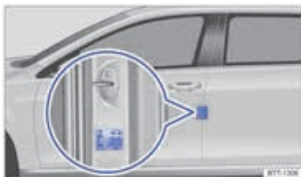
شکل ۱۴۹: روی ستون درب سمت راننده: برچسب فشار لاستیک
