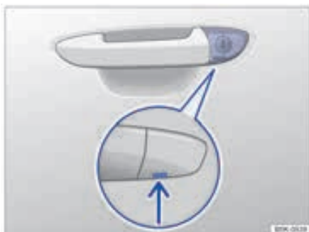
شکل ۴۵ : دستگیره درب راننده: استوانه مخفی قفل درب
