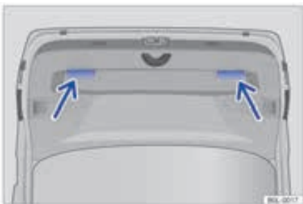
شکل ۵۱ : درب صندوق عقب باز شده: دستگیره فرورفته برای بستن درب صندوق عقب
