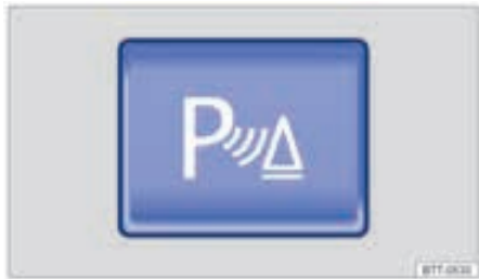
شکل ۱۰: کنسول مرکزی: دکمه روشن/خاموش سیستم هشدار فاصله پارک (نمودار شماتیک)
