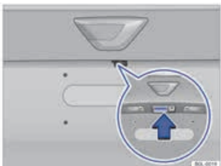
شکل ۵۰ : باز کردن درب صندوق عقب از بیرون
