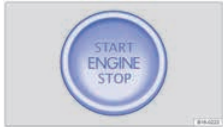
شکل ۸۲ : قسمت پایینی کنسول مرکزی: دکمه استارت/توقف برای راه اندازی موتور
