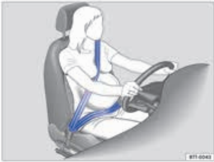
شکل ۲۹ : تصویر محل صحیح بستن کمربند ایمنی برای زنان باردار
