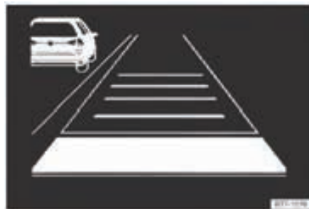
شکل ۹۳: در پشت آمپر: وسیله نقلیه ای با سرعت کمتر از خودرو در خط چپ مشخص می شود (نمودار شماتیک)
