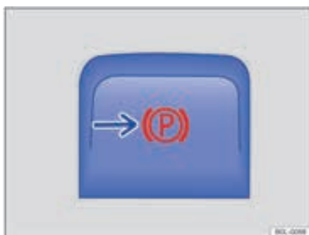
شکل ۹۸ : کلید ترمز پارک الکترونیک
