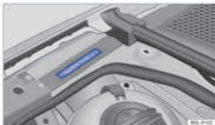
شکل ۱۵۸: در محفظه موتور: کد شناسایی خودرو
