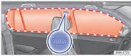
شکل ۳۴ : سمت چپ خودرو: موقعیت نصب و محدوده عملکرد کیسه هوای پرده ای
