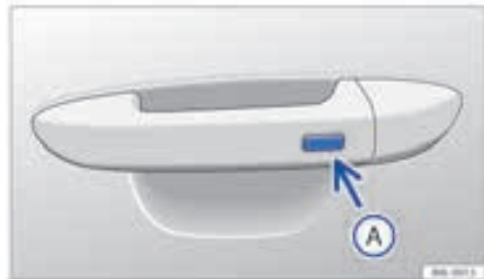
شکل ۴۴ : دستگیره درب؛ دکمه عملکرد دسترسی بدون کلید
