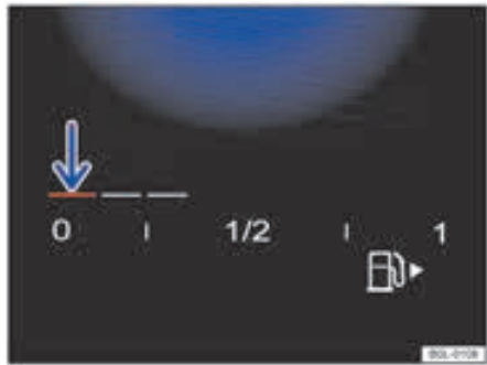
شکل ۱۴ : نشانگر میزان سوخت در مدل های دیجیتال
