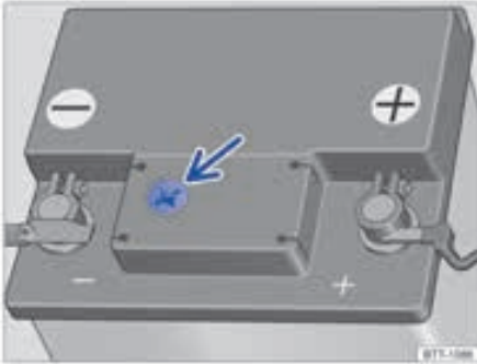
شکل ۱۳۹: مشاهده سوراخ باتری در سمت بالایی یک باتری ۱۲ ولتی سوار بر خودرو
