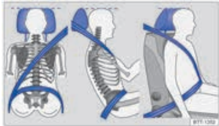
شکل ۲۸ : تصویر تنظیم صحیح کمربند ایمنی و پشتی سر
