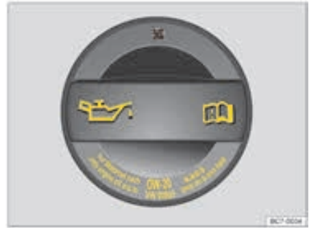
شکل ۱۳۶: در قسمت محافظه موتور: درپوش برای پرکننده روغن موتور
