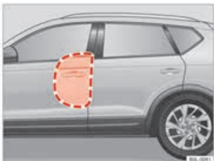
شکل ۳۲: سمت چپ خودرو: دامنه گسترش کیسه هوای جانبی.
