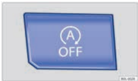
شکل ۸۴: قسمت بالای کنسول مرکزی: دکمه های برای سامانه روشن/خاموش اتوماتیک موتور
