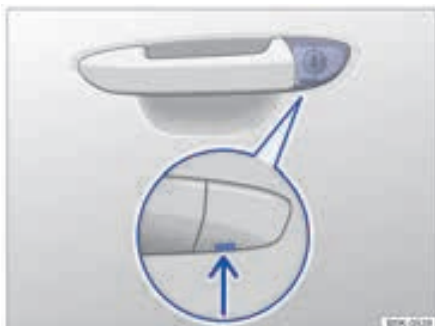
شکل ۴۶ : دستگیره درب راننده؛ سیلندر مخفی قفل درب
