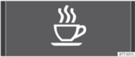
شکل ۱۲: نمایشگر پشت آمپر: علامت سامانه تشخیص خواب آلودگی راننده
