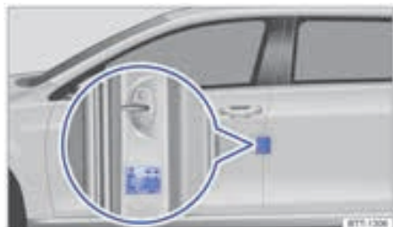
شکل ۱۴۴: در ستون درب سمت راننده: علائم فشار باد لاستیک
