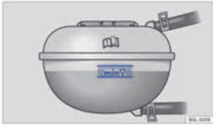
شکل ۱۳۷: در محفظه موتور: علامت گذاری مخزن انبساط مایع خنک کننده موتور
