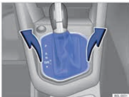
شکل ۸۸ : برداشتن صفحه پوشش دنده
