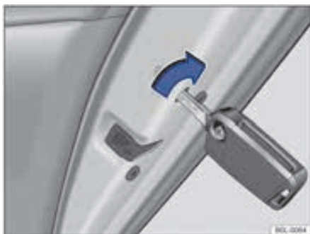
شکل ۴۸: وجه انتهایی درب سمت راست؛ قفل کردن وسیله نقلیه با کلید اضطراری
