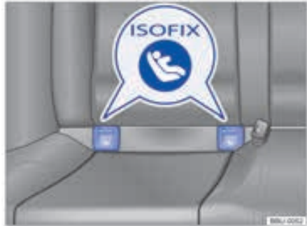
شکل ۳۷ : نشانه های شناسایی برای نقاط ثابت ISOFIX برای صندلی کودک
