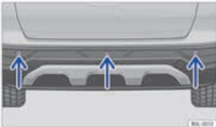
شکل ۱۰۰ : سپر عقب: سنسور اولتراسونیک از سیستم هشدار فاصله پارک عقب
