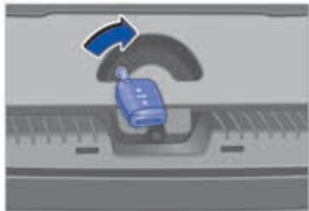
شکل ۵۲: داخل صندوق عقب؛ باز کردن قفل درب عقب
