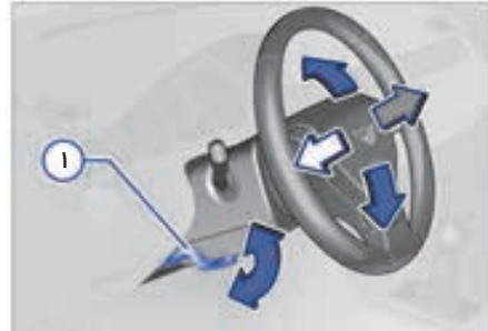
شکل ۵۴: زیر غریبک فرمان، روی پوشش ستون فرمان: اهرم تنظیم مکانیکی موقعیت غریبک فرمان.
