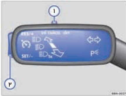
شکل ۹۰: سمت چپ ستون فرمان: سوئیچ ها و دکمه‌ها برای عملکرد GRA
