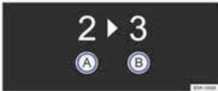
شکل ۷۹: روی نمایشگر پشت آمپر: پیشنهاد تعویض دنده
