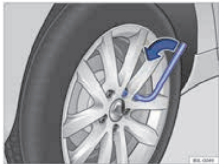
شکل ۱۵۳: تعویض چرخ: برداشتن پیچ و مهره چرخ با آچار پیچ چرخ
