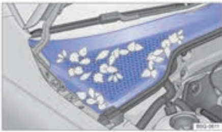
شکل ۱۵۴: بین محفظه موتور و شیشه جلو: شیار نظیبه
