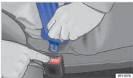
شکل ۲۷: تصویر رها کردن زیانه از سگک کمربند ایمنی
