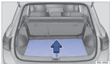
شکل ۱۱۵: داخل صندوق عقب: بلند کردن کفی صندوق عقب
