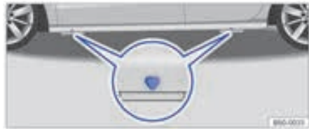
شکل ۱۵۱: نقطه پشتیبانی جک
