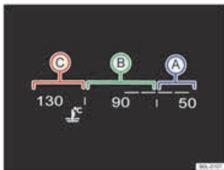
شکل ۱۶: تصویر نمایش دمای مایع خنک کننده موتور در پشت آمپر دیجیتال
