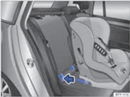
شکل ۳۸ : نمودار شماتیک: نصب صندلی کودک ISOFIX با دسته های ثابت
