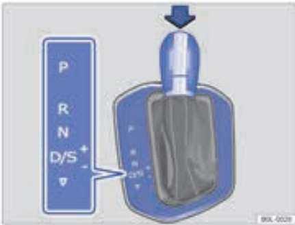
شکل ۸۶ : دسته دنده اتوماتیک مجهز به دکمه قفل
