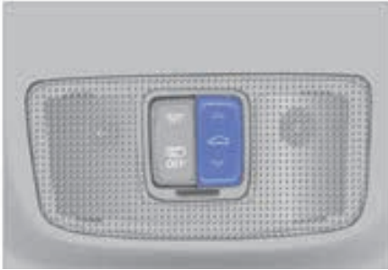
شکل ۵۳: دکمه‌هایی برای باز کردن کشویی/شیبدار کردن سانروف
