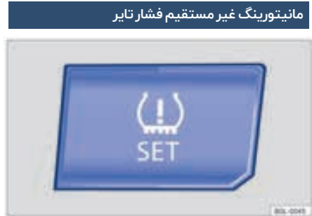
شکل ۱۴۱: کنسول مرکزی: دکمه بررسی فشار تایر
