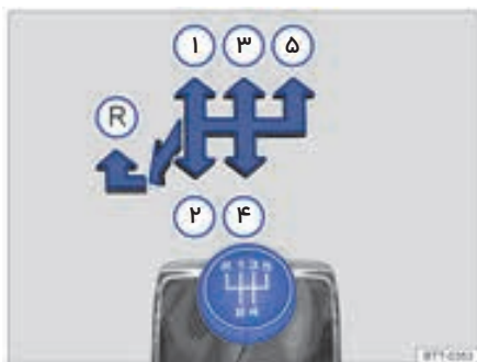
شکل ۸۵: نمودار شمایک موقعیت دنده گیربکس دستی ۵ دنده
