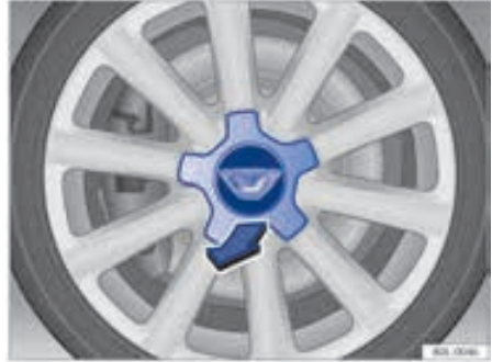
شکل ۱۴۸: بیرون کشیدن صفحه پوشش مرکزی چرخ
