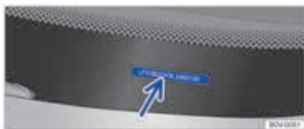
شکل ۱۵۹: روی شیشه جلو: کد شناسایی خودرو
