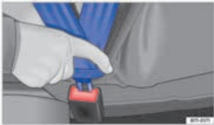
شکل ۲۶: تصویر قرار دادن زیانه کمربند ایمنی در سگک.
