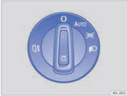
شکل ۶۵: در کنارگریبک فرمان؛ کلید چراغ‌ها (این نوع فقط یک نمونه است)
