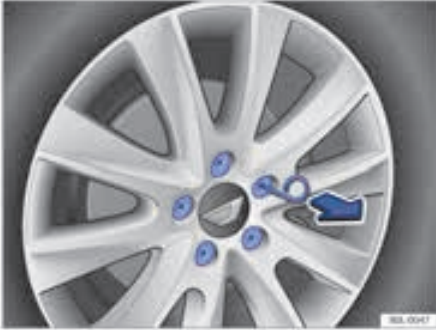
شکل ۱۴۹: برداشتن کلاهک محافظ از پیچ چرخ
