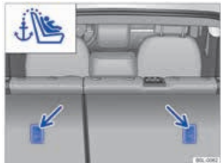
شکل ۳۹ : سگک در پشتی صندلی عقب برای اتصال بند بالایی
