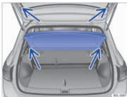
شکل ۱۱۴: درپوش صندوق عقب: جدا کردن و نصب کردن درپوش صندوق عقب
