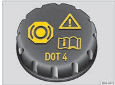
شکل ۱۳۸: در محفظه موتور: درپوش مخزن روغن ترمز
