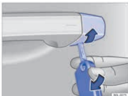
شکل ۴۷ : دستگیره در راننده؛ روش باز کردن درپوش
