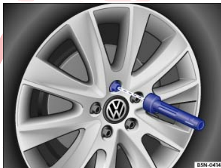
تصویر 284 تعویض چرخ: پیچ‌های چرخ را با استفاده از آچار چرخ باز کنید.
