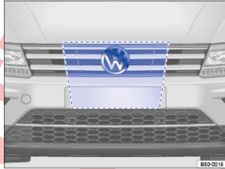
تصویر 160 در توری خنک‌کننده پشت نشانه VW: سنسور رادار و محدوده خالی اطراف سنسور.
