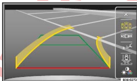
تصویر 183 نمایشگر برای سیستم دوربین دید عقب: حالت 1 را انتخاب کنید.
