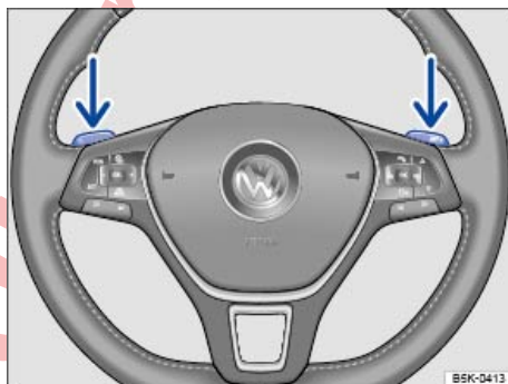
تصویر 140 غربیلك فرمان و دکمه تعویض دنده برای تیپترونیك.
