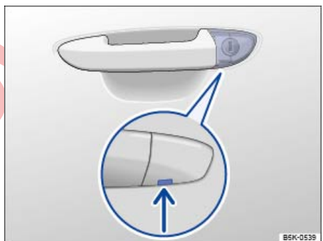
تصویر 75 دستگیره درب راننده: سیلندر مخفی قفل.
