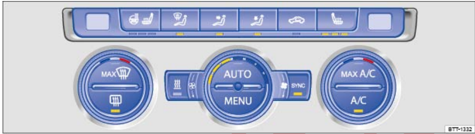
تصویر 122 در قسمت فوقانی کنسول مرکزی: کنترل‌های سیستم کلایماترونیك.
