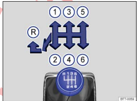
تصویر 136 الگوی تعویض دنده در گیربکس 6 دنده‌ای.
