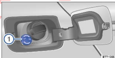
تصویر 233 پشت دریچه باک: گلوبی پرکننده مخزن برای AdBlue.
