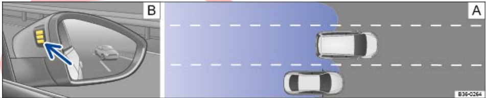
تصویر 171 [A] رانندگی در موقعیت‌هایی که با تغییر مسیر و سبقت گرفتن خودروهای دیگر مواجه می‌شوید. [B] نمایشگر دیداری در آینه بغل سمت راست.
