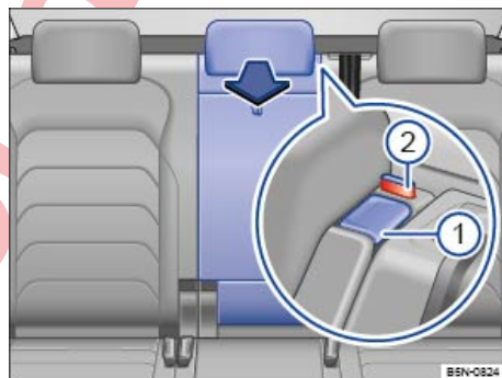
تصویر 225 در پشتی صندلی عقب: باز کردن دریچه دسترسی به صندوق عقب.
