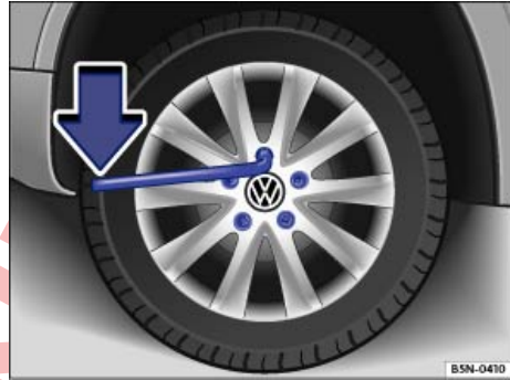
تصویر 280 تعویض چرخ: باز کردن پیچ‌های چرخ.
